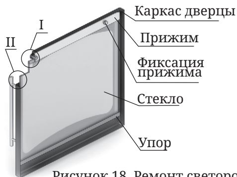
Рисунок 18. Ремонт светорозрачного экрана дверцы модификации «Витра»
