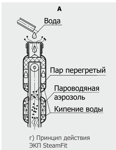
Рис. 2 Устройство электрокаменок SteamFit (СтимФит)
