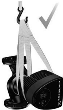
Рис. 7 Правильный способ строповки насоса
