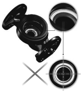
Рис. 16 Неправильно выровненная система уплотнений
