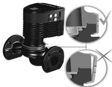
Рис. 17 Закрепление головной части насоса на корпусе
