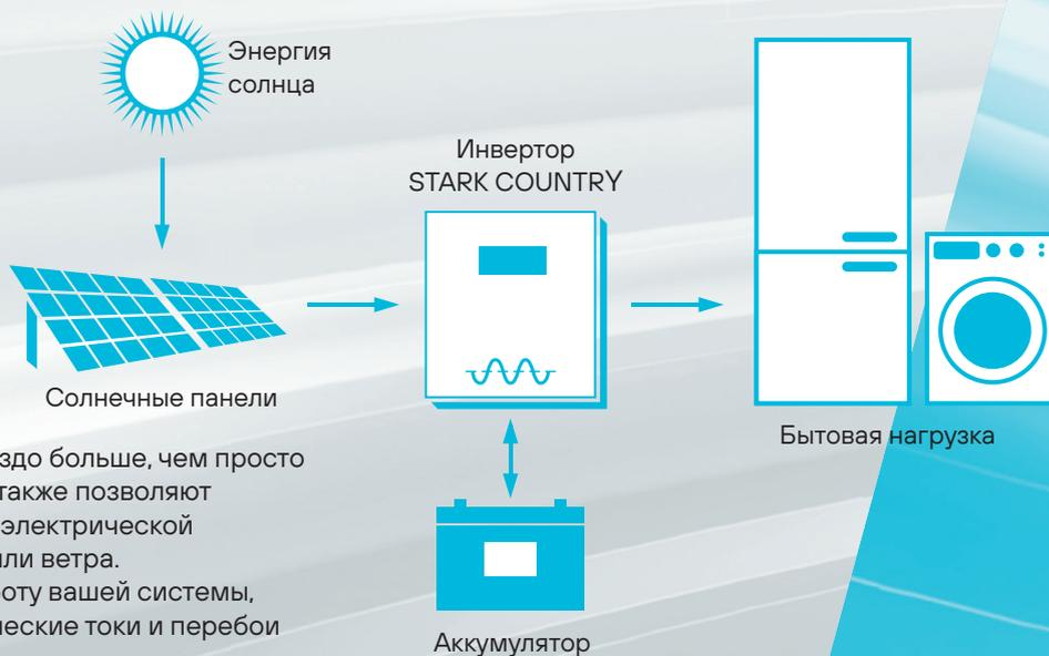
Солнечные инверторы делают гораздо больше, чем просто преобразуют электричество — они также позволяют извлечь максимальное количество электрической энергии, производимой от солнца или ветра. Они обеспечивают безопасную работу вашей системы, обнаруживая аномальные электрические токи и перебои в энергоснабжении.
