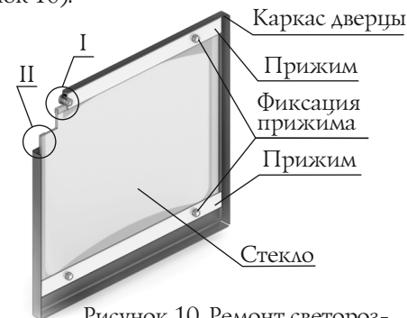
Рисунок 10. Ремонт светопрозрачного экрана дверцы.
