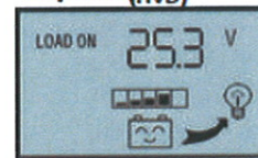
8. Возобновление питания нагрузки (программируемый параметр) (LVR)
