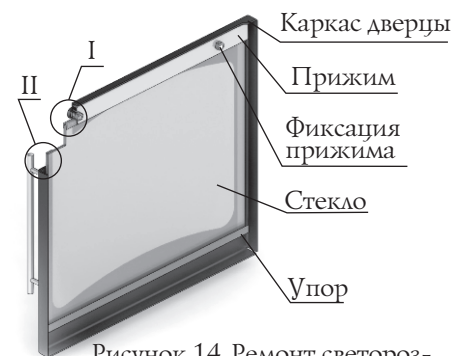
Рисунок 14. Ремонт светорозрачного экрана дверцы печи «Витрувия»
