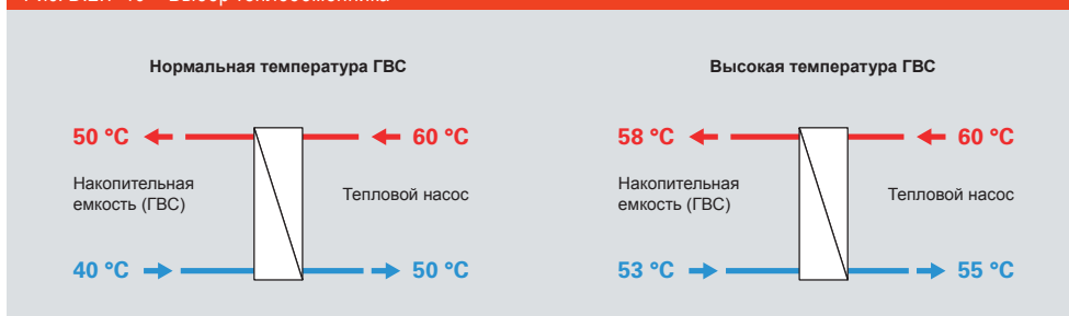
Рис. D.2.1-16 Выбор теплообменника
